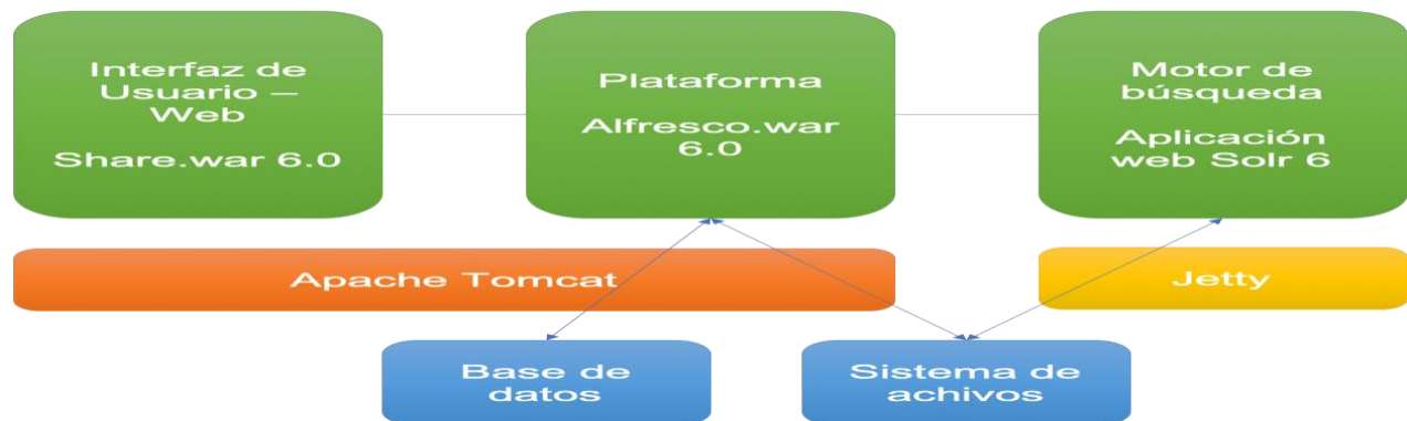
Figura 7. Arquitectura del sistema gestor de contenidos Alfresco Community Edition. Fuente: Alfresco Software Inc. (2018).
