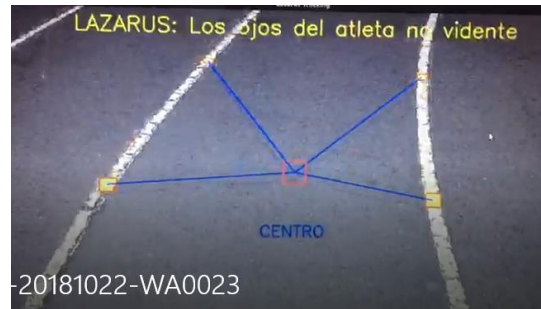
Ilustración 5. Captura de video, la posición del corredor se encuentre dentro del rango aceptable por lo tanto indica CENTRO y ninguno de los microvibradores se activa. Fuente. Propia
