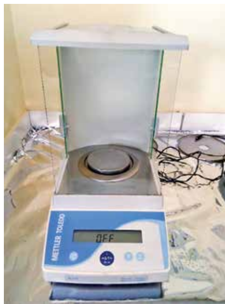
Figura 1 Balanza analítica para el pesado, con un nivel de legibilidad de hasta 0,1 mg.
