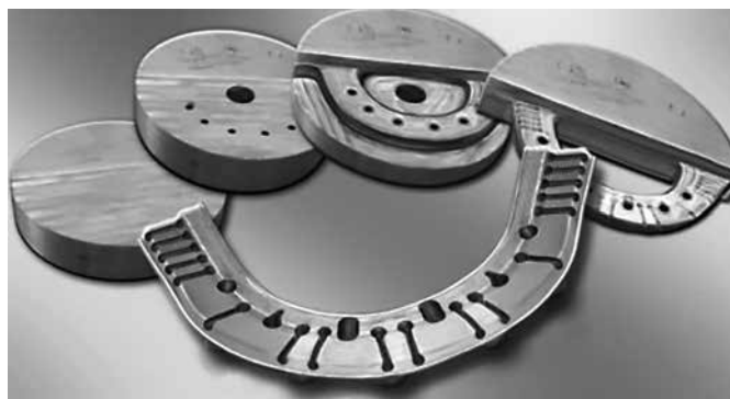
Fig. 4 Diagrama de bloque de titanio maquinado utilizando tecnología CAD/CAM.
