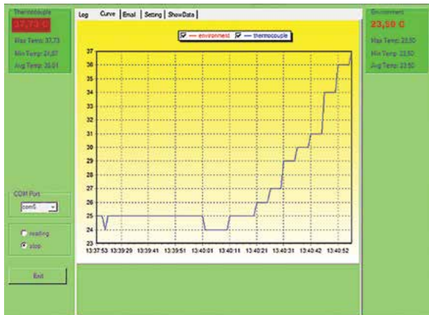
Medición de la lámpara LED marca V.A.L.O, al fotocurar durante 40 segundos. (Modo normal 1000 mW/cm 2 )
