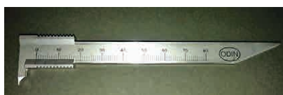
Fotografía 1. Pie de metro manual marca ODIN
