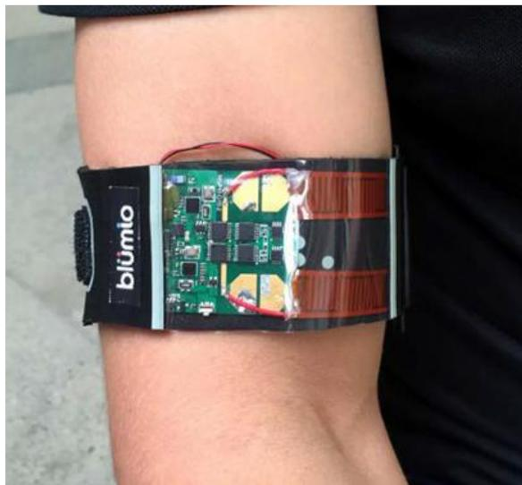
Figura 1. Prototipo funcional, medidor de presión arterial con diseño de brazalete. Fuente: Blumio, MIT Technology Review [3].
